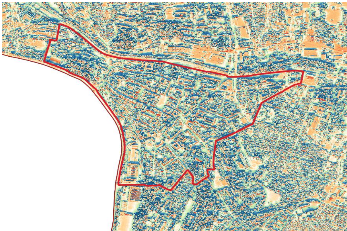
Ilustracja 4 Względna intensywność nasłonecznienia. Tereny o barwie białej są nasłonecznione tak, jak odkryty teren płaski, niebieskie – poniżej tej wartości, pomarańczowe – powyżej.. Obliczone na podstawie modelu NMPT pozyskanego z PZGiK z użyciem algorytmu CompareToFlatTerrain. w programie SAGA GIS 8.3
